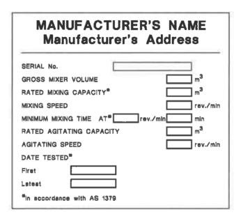
FIGURE 3.1 SAMPLE IDENTIFICATION PLATE FOR BATCH MIXERS
